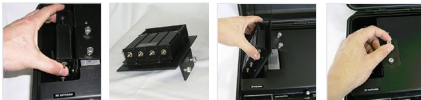
1. برگرداندن سریع اتصال 2. جدا کردن دیپلکسر از پوش 3. انتخاب دیپلکسر برای چینل 4. وارد کردن دیپلکسر جدید در پوش
